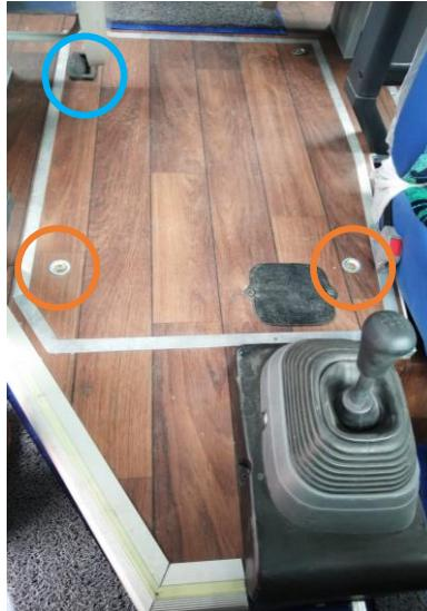
La tapa se ubica al lado derecho del puesto del conductor y sirve para inspeccionar diversas situaciones referidas al motor. Existen dos tipos de tapas.
